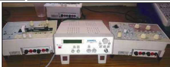
इलेक्ट्रिकल मशीन लैब के उपकरण (LVDT ट्रेनर, 3MHz डिजिटल फंक्शन जनरेटर, फोटो कंडक्टिव सेल (LDR) ट्रेनर)
